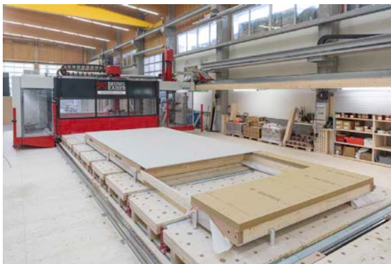
Die Holzbauelemente samt Wärmedämmschicht aus GUTEX Holzfaserplatten wurden in der Montagehalle vorgefertigt.
